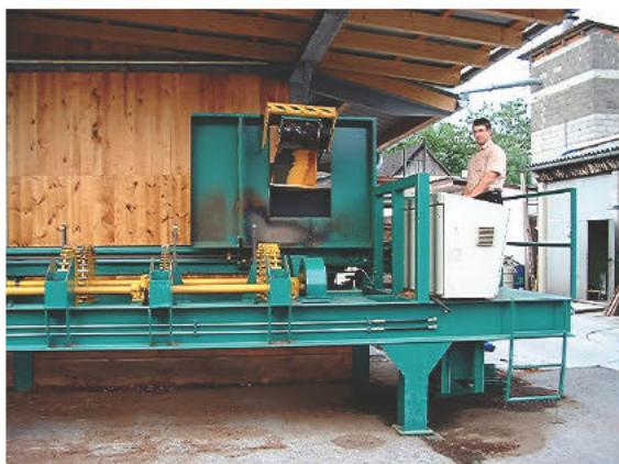
Entrindungsmaschine Typ H256/800 für manuelle Bedienung. Einfache Ausführung. Optimales Preis-Leistungsverhältnis. Geeignet für kleinere Sägewerke.
