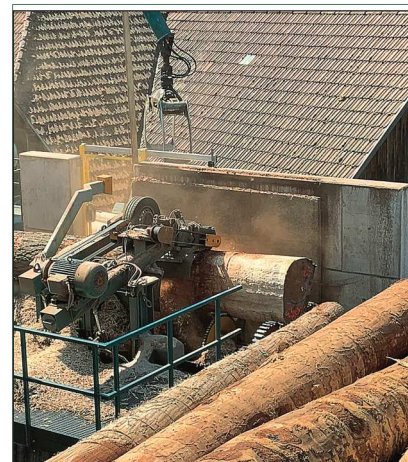
Direkt angrenzend an das Betriebsgelände des Sägewerks Meßmer in Welschensteinach liegt die Wohnbebauung des Ortes. Die Lärmreduktion am Fräskopfentrinder, die SWT Maschinenbau hier erstmalig mit einer Einhausung erreicht hat, war deshalb eine wichtige Maßnahme bei dieser Investition. Die Einhausung kann mit dem Kranwagen entfernt werden, dahinter (zweites Bild von rechts) wird die zum Betriebsgelände hin erhöhte Betonwand sichtbar, die zu einer weiteren Reduzierung der Schallemissionen beiträgt. Die hier angebrachte Sicherheitstür (Bild rechts) bildet den einzigen Zugang zur Entrindungsanlage.
