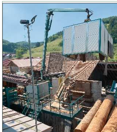
Direkt angrenzend an das Betriebsgelände des Sägewerks Meßmer in Welschensteinach liegt die Wohnbebauung des Ortes. Die Lärmreduktion am Fräskopfentrinder, die SWT Maschinenbau hier erstmalig mit einer Einhausung erreicht hat, war deshalb eine wichtige Maßnahme bei dieser Investition. Die Einhausung kann mit dem Kranwagen entfernt werden, dahinter (zweites Bild von rechts) wird die zum Betriebsgelände hin erhöhte Betonwand sichtbar, die zu einer weiteren Reduzierung der Schallemissionen beiträgt. Die hier angebrachte Sicherheitstür (Bild rechts) bildet den einzigen Zugang zur Entrindungsanlage.
