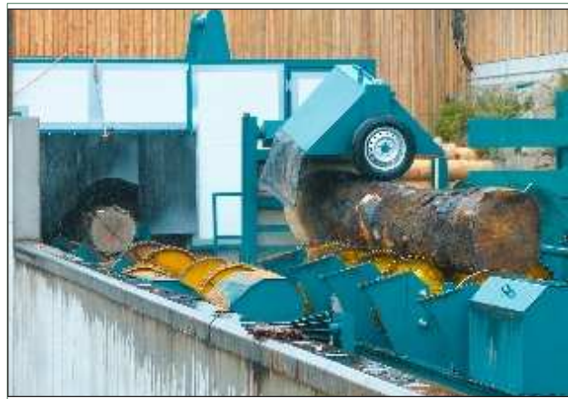
Wurzelreduzierung (rechts) und Gleiswagen im Einlauf der Fräskopfstation (links)
