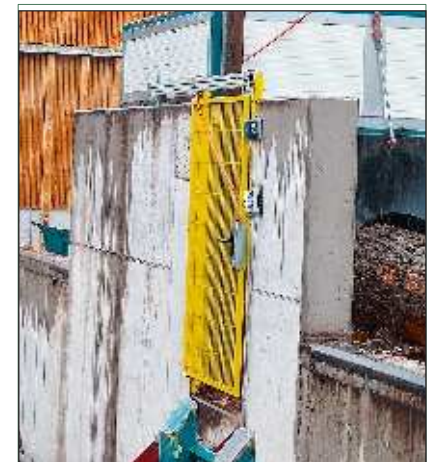
Direkt angrenzend an das Betriebsgelände des Sägewerks Meßmer in Welschensteinach liegt die Wohnbebauung des Ortes. Die Lärmreduktion am Fräskopfentrinder, die SWT Maschinenbau hier erstmalig mit einer Einhausung erreicht hat, war deshalb eine wichtige Maßnahme bei dieser Investition. Die Einhausung kann mit dem Kranwagen entfernt werden, dahinter (zweites Bild von rechts) wird die zum Betriebsgelände hin erhöhte Betonwand sichtbar, die zu einer weiteren Reduzierung der Schallemissionen beiträgt. Die hier angebrachte Sicherheitstür (Bild rechts) bildet den einzigen Zugang zur Entrindungsanlage.
