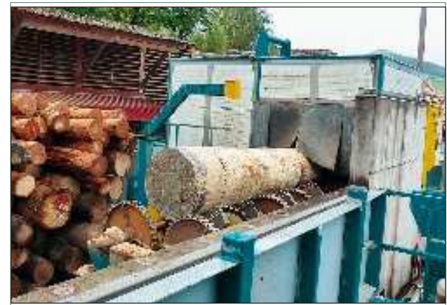
Längenvermessung des entrindeten Stammes auf dem Gleiswagen vor dem Stammabwurf
