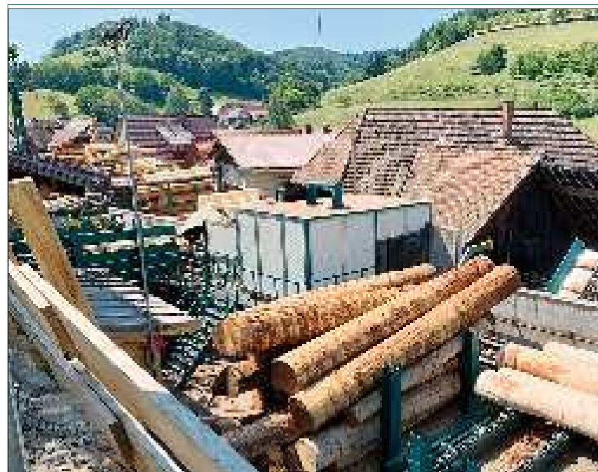
Direkt angrenzend an das Betriebsgelände des Sägewerks Meßmer in Welschensteinach liegt die Wohnbebauung des Ortes. Die Lärmreduktion am Fräskopfentrinder, die SWT Maschinenbau hier erstmalig mit einer Einhausung erreicht hat, war deshalb eine wichtige Maßnahme bei dieser Investition. Die Einhausung kann mit dem Kranwagen entfernt werden, dahinter (zweites Bild von rechts) wird die zum Betriebsgelände hin erhöhte Betonwand sichtbar, die zu einer weiteren Reduzierung der Schallemissionen beiträgt. Die hier angebrachte Sicherheitstür (Bild rechts) bildet den einzigen Zugang zur Entrindungsanlage.
