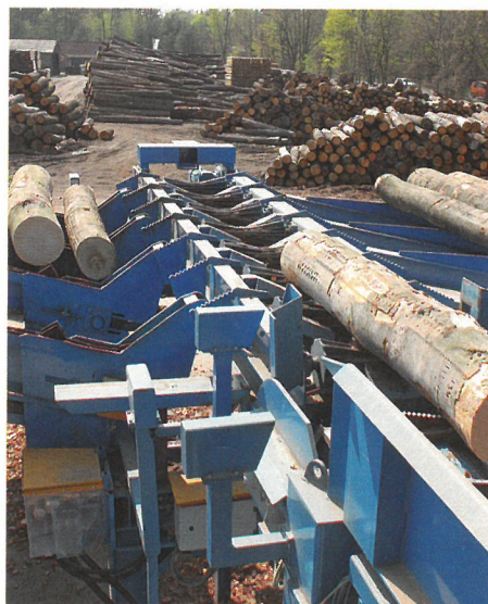
Verteilstation: links geht es zur Entrindung, rechts Abwurfbox für Blockware
