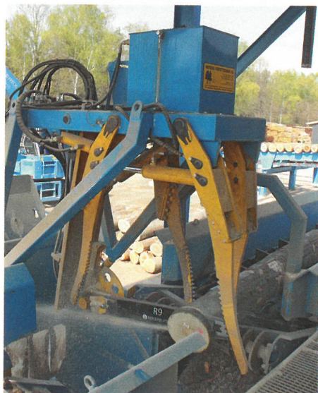
Neuheit: Kettsäge klappt nach Schnitt nach hinten und fährt nicht durch das Holz nach oben
