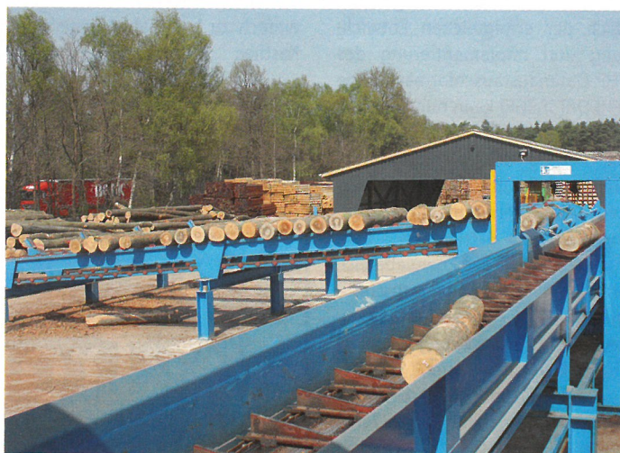
Querförderer dient als Puffer bei der Aufgabe (li.), im Längsdurchlauf erfolgt die Messung der Stämme (re.)
