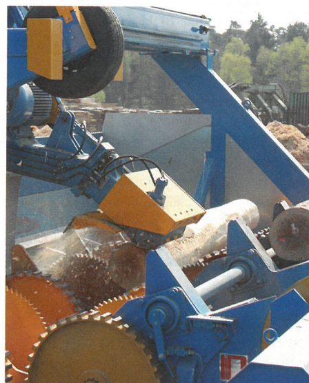
Leistungsstarke Fräskopfentrindung von Häwa für Laubholz
