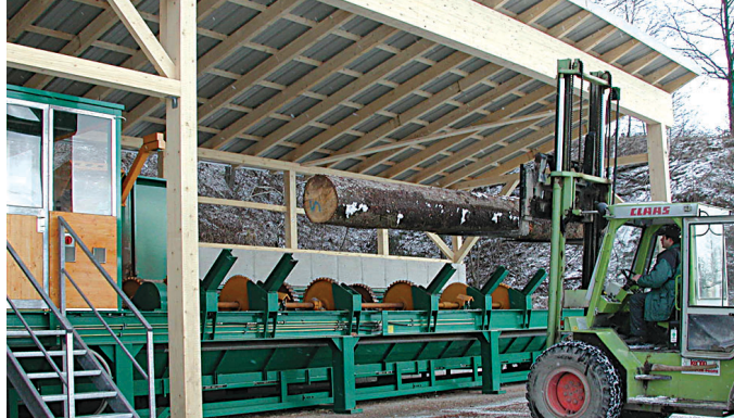
Die Anlage wird mit dem Stapler beschickt
